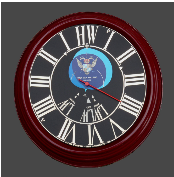
Afb.4 Vier uur na hoog water: Getijklok van Hoek van Holland hangt in de entree van het publiek toegankelijke Keringhuis van de Maeslandkering . ( Deze kering bevindt zich tussen Maassluis en Hoek van Holland ). In de getijvorm zien we het wapen van het Hoogheemraadschap Delfland (Deze wandklok heeft een diameter van 59 cm). Verder vinden we onderaan op de wijzerplaat meerdere laagwater aanduidingen. Die midden onderaan betreft een gemiddeld laagwater, links en rechts daarvan doen zich voor tijdens het springtij dat tweemaal per maand optreedt. Het kleine blauwe puntje dat onderaan de getijvorm uitsteekt betreft een aggr.
